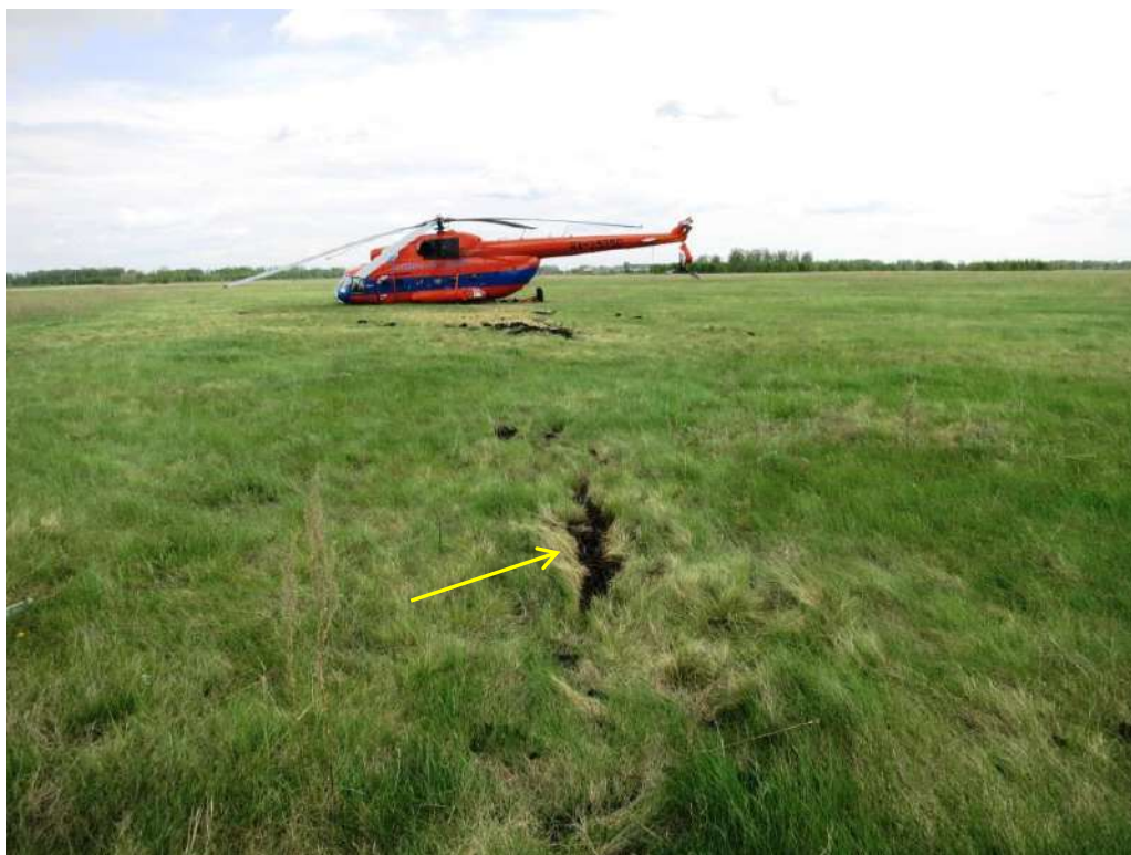
Рис. 4. Место столкновения хвостовой опоры и лопастей РВ с земной поверхностью (показано стрелкой)
