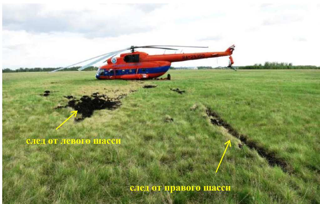
Рис. 5. Следы на земной поверхности от правого и левого шасси
