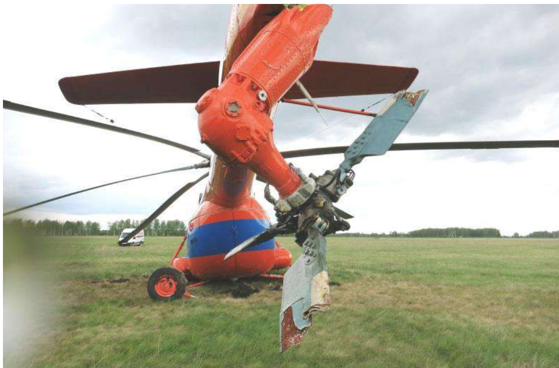
Рис. 12. Вертолёт на месте АП. Вид сзади. Разрушенные концевая балка и РВ
