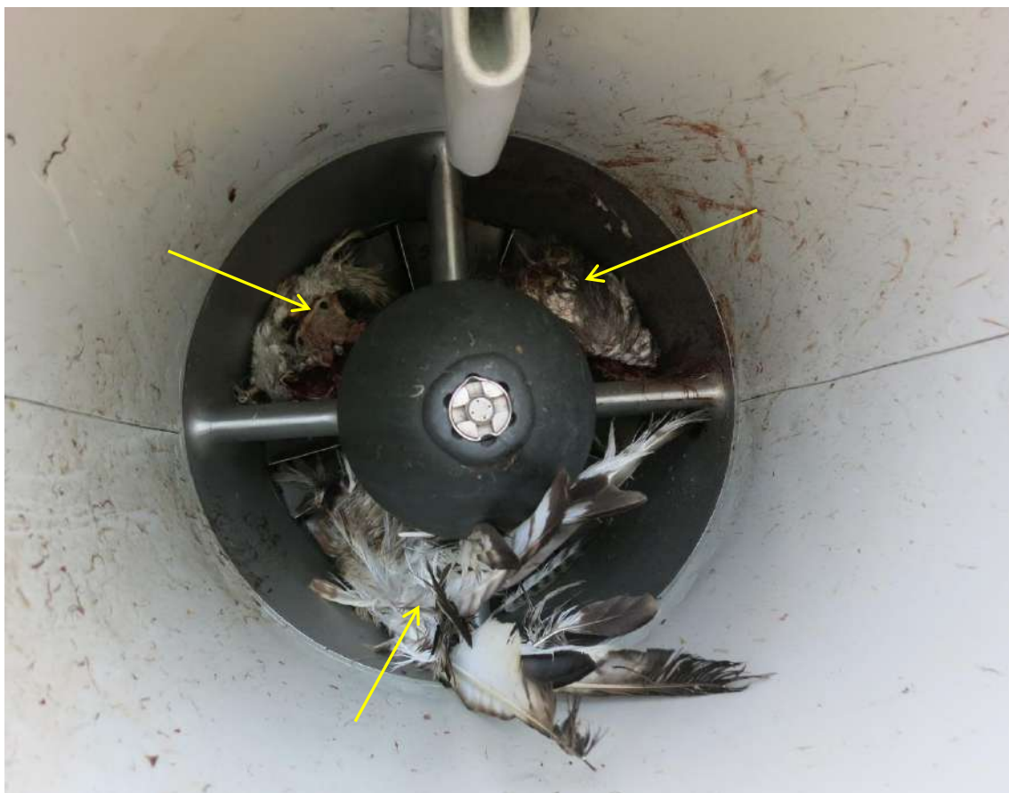
Рис. 7. Воздухозаборник левого двигателя с фрагментами птицы (показаны стрелками)
